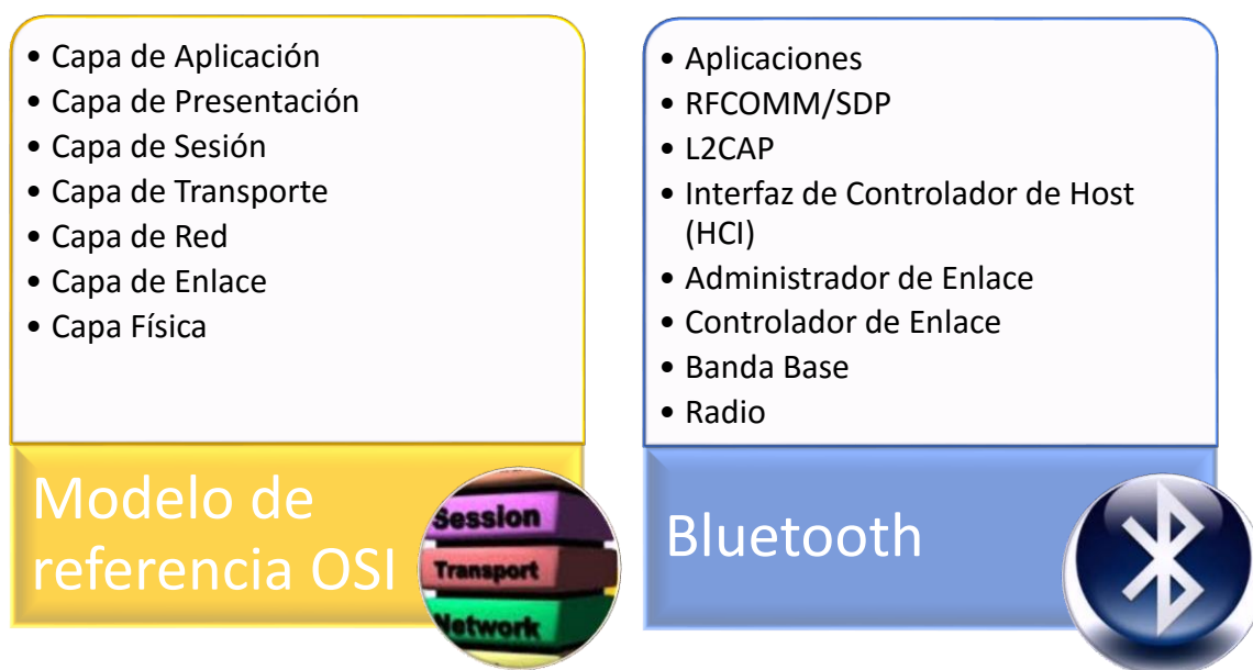
Figura 2-8. Diferencia entre modelo OSI y Bluetooth
