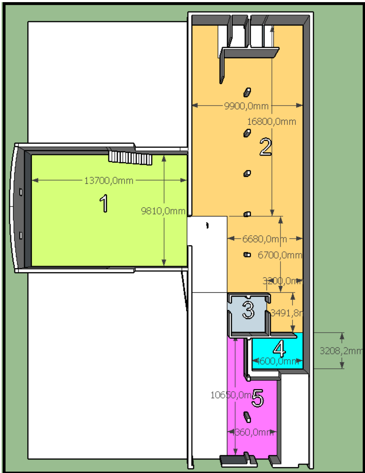
Fig-31- (distribución de los sectores de incendio en que se dividió la empresa)
