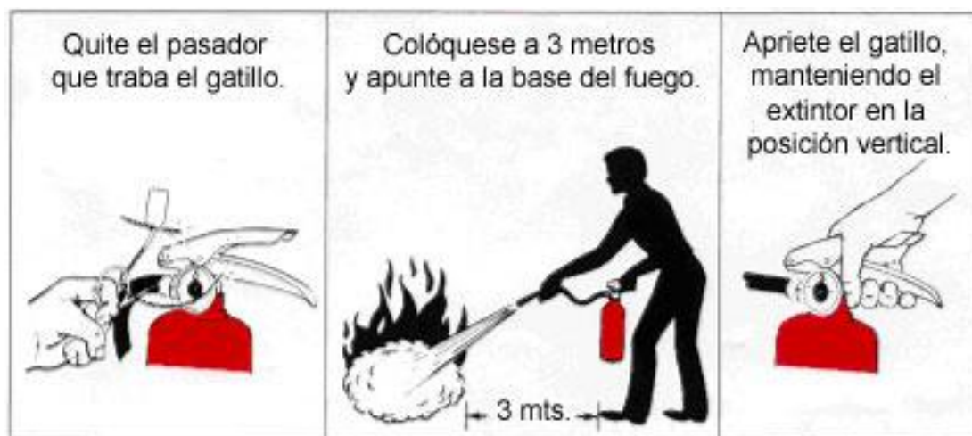
Fig-34-(instrucciones para uso de matafuego)
