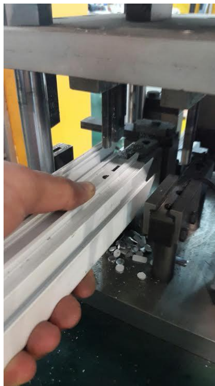
Fig-23-(proceso de punzonado de un perfil)
