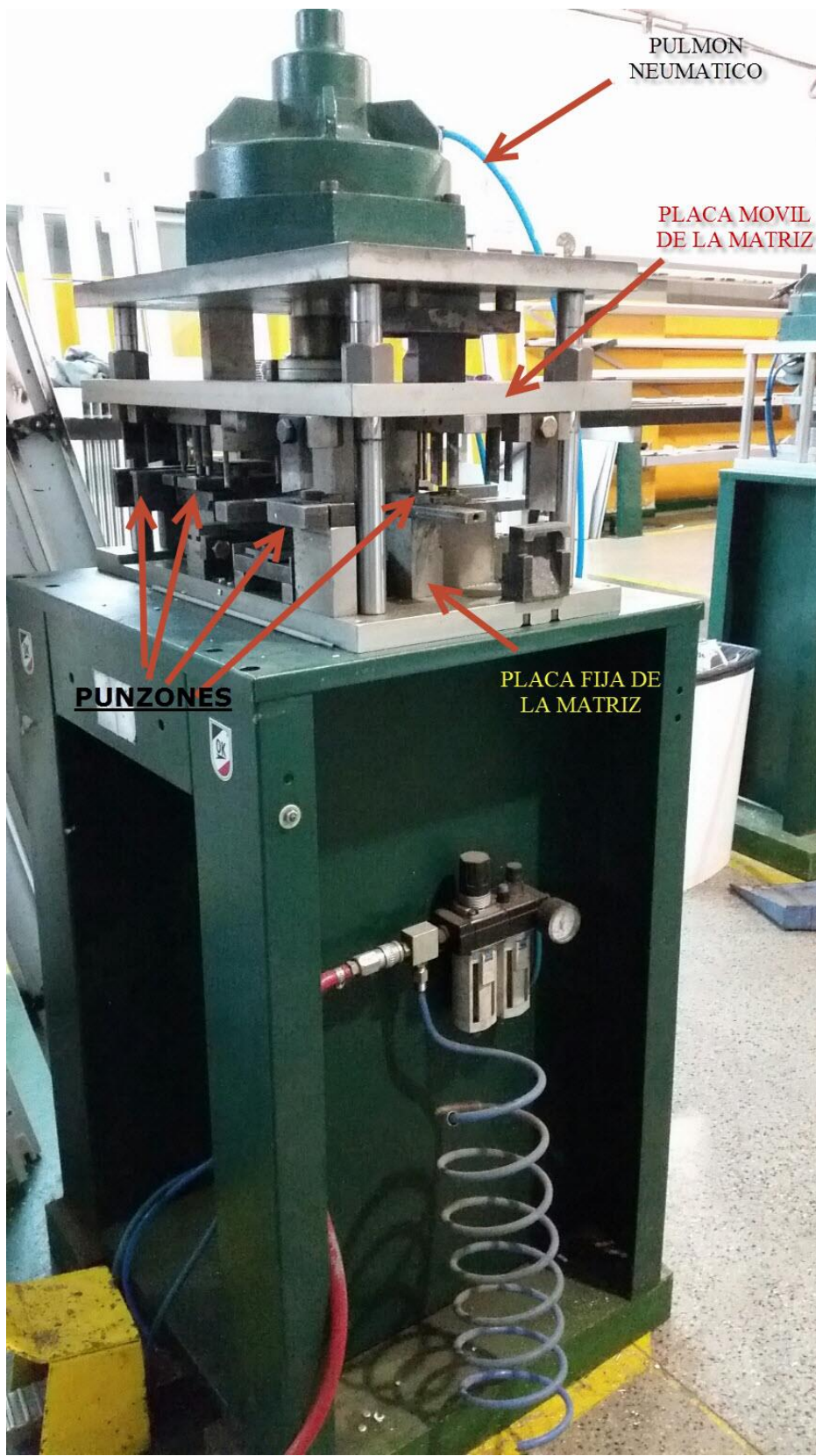
Fig-24-(punzonadora neumática para procesamiento de perfiles)
