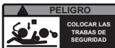
Figura 12. Accidente por aplastamiento en trabajos de regulación debajo de la sembradora
