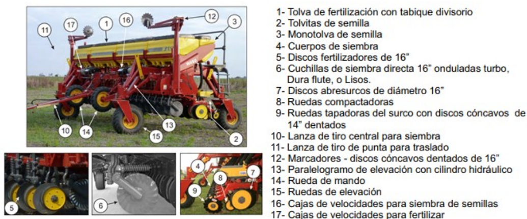
Figura 10. Identificación de las partes del equipo de siembra
