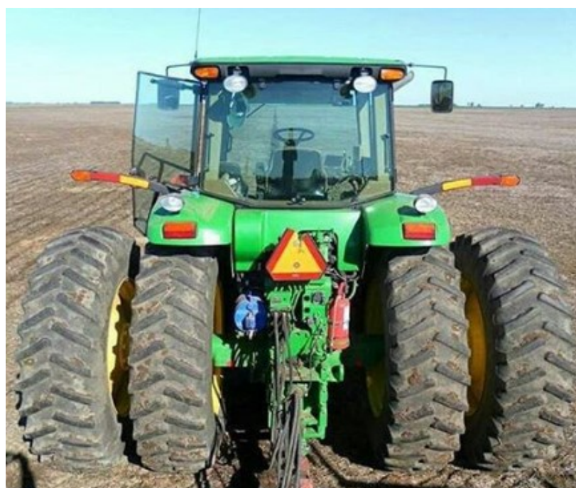
Figura 4. Tractor John Deere 7200J realizando trabajos de siembra, con conexiones ordenadas y en buen estado, matafuego y baliza.
