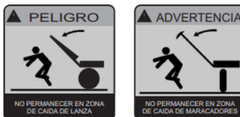
Figura 11. Señales de seguridad que advierten que no se debe permanecer en esa zona.
