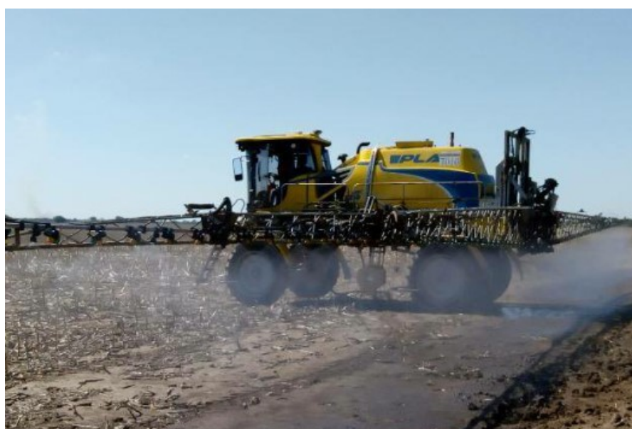
Figura 5. Máquina pulverizadora autopropulsada Pla realizando trabajos de aplicación de agroquímicos sobre un lote agrícola previo a la siembra.
