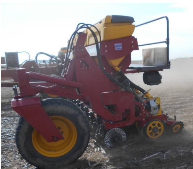
Figura 5. Labor de siembra directa de semillas del cultivo de maíz, sobre un lote con rastrojo de soja con sembradora Súper Walter W650
