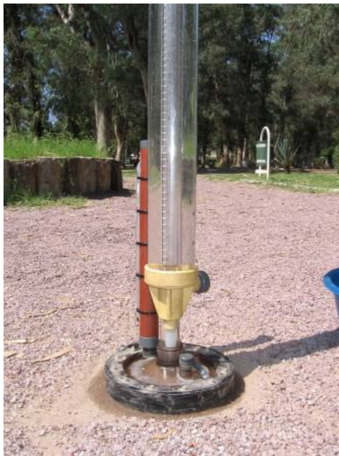
Figura 11.- Medición de infiltración in situ con infiltrómetro de disco de tensión.
