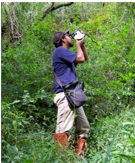
Figura 5. Medición de ángulo con un Blume-Leiss para determinación de altura de árboles.
